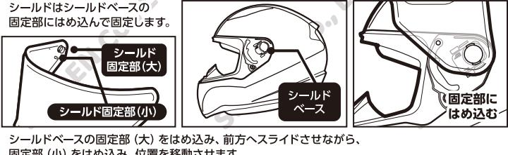
シールドベースの固定部(大)をはめ込み、前方へスライドさせながら、固定部(小)をはめ込み、位置を移動させます。
